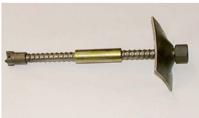
Obr.4 – Tyčová kotva IBO se ztracenou vrtací korunkou utahovací maticí a podložkou
